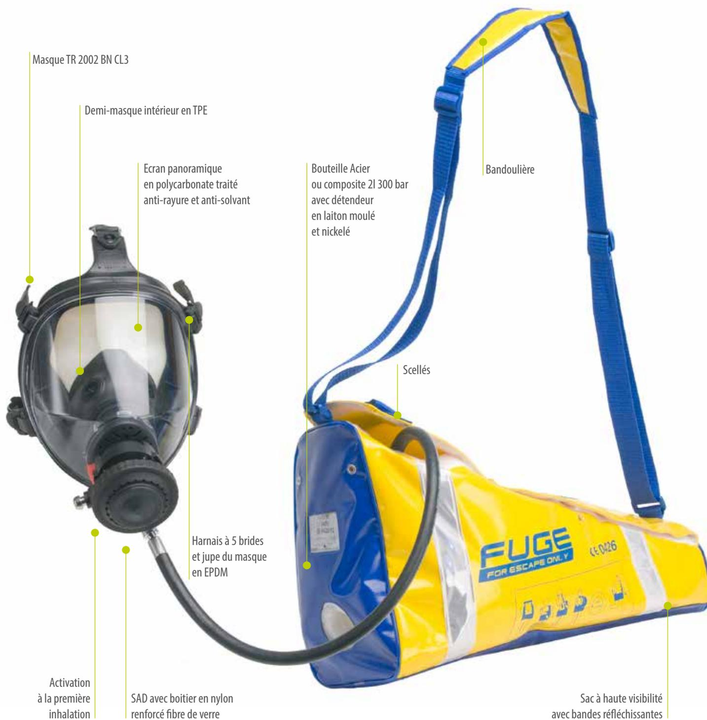
Le **FUGE** est un ARI d'évacuation avec soupape à la demande et bouteille 2 l / 300 bar qui fournit un débit d'air respirable d'une durée garantie minimale de 15 minutes.
