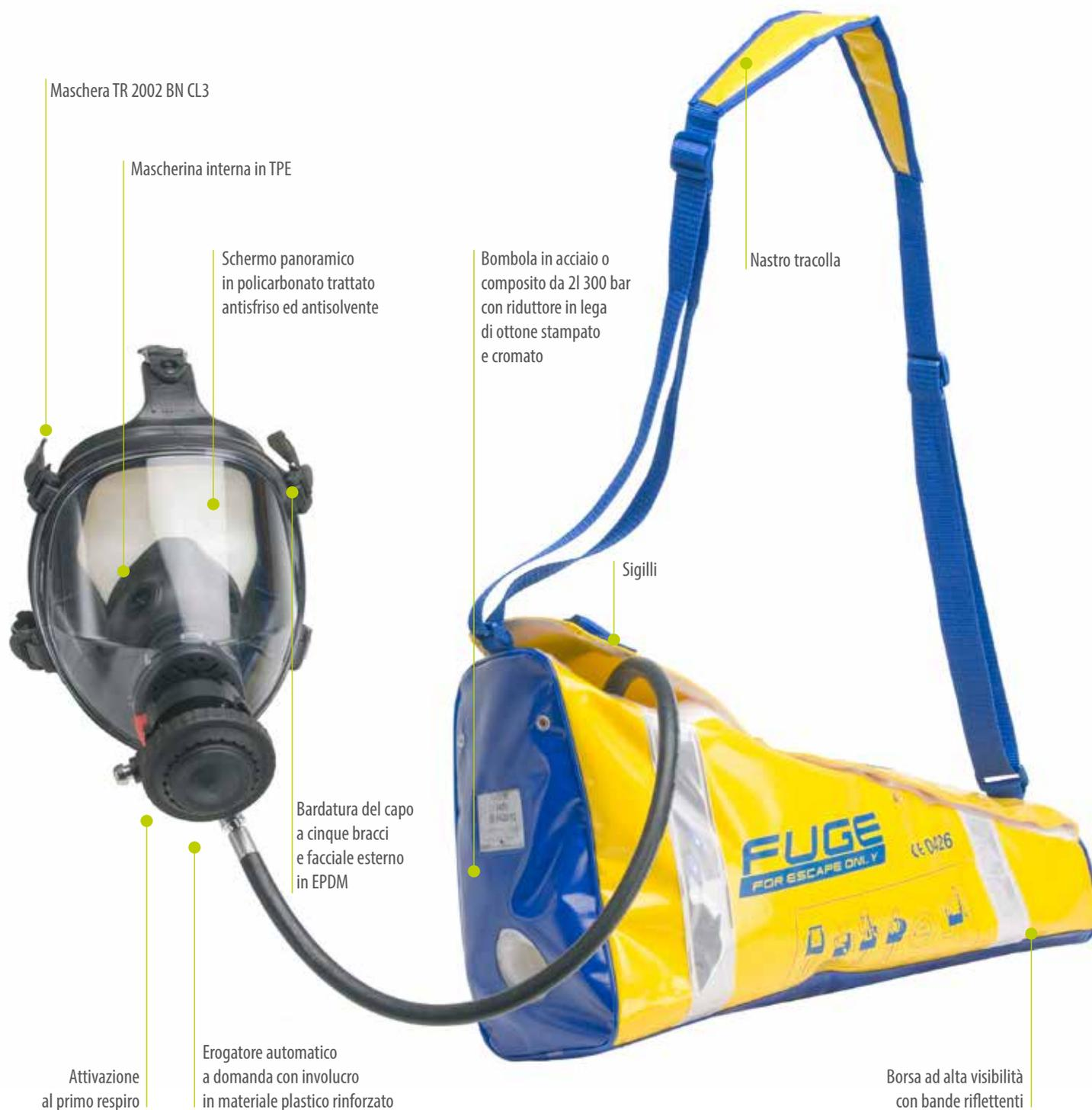
**FUGE** è un autorespiratore ad aria compressa per la fuga che in caso di emergenza fornisce un flusso di aria respirabile a domanda, per un tempo minimo garantito di 15 minuti con bombola da 2 l 300 bar.
